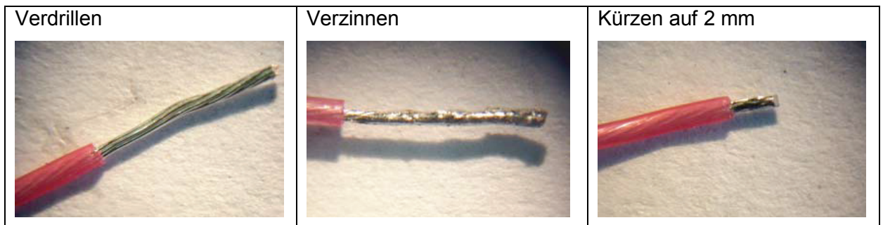
Abb. 1: Vorbereitung der Litze
