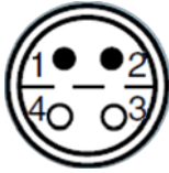
Abbildung 21: Sensoranschluss: LEMO-Stecker FFA.0S.304.CLAC32Y, Kontaktseite
