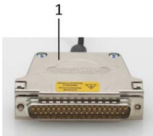
Abbildung 6: Stecker D-Sub 37 (m) am Anschlusskabel des S-331.xSH
